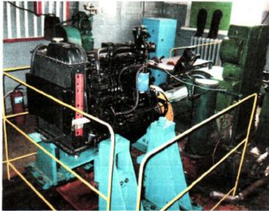
Рис. 1 – Стенд для випробування дизеля
